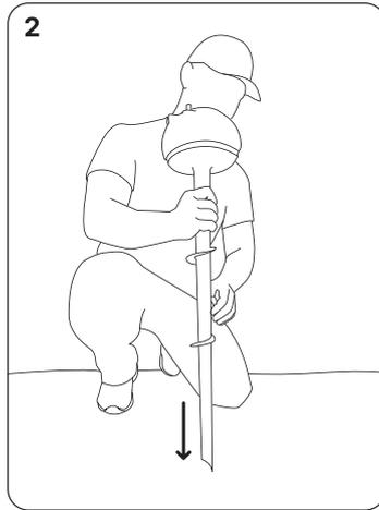
2 Quite la tapa de protección (si la tiene) y desenrosque la antena. Introduzca el sensor en el orificio y enrósquelo con cuidado, hasta que se mantenga firme en el suelo. No haga fuerza hacia abajo. Asegúrese de que no queden restos (plantas, hojas, etc.) atrapados en el sensor durante la instalación.
