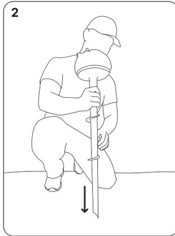
Entfernen Sie die Schutzhülle und schrauben Sie die Antenne ab. Setzen Sie den Sensor in das Loch ein und schrauben Sie ihn vorsichtig ein, bis er fest im Boden steht. Keinen Druck nach unten ausüben. Vergewissern Sie sich, dass bei der Installation keine Pflanzenreste, Blätter oder Ähnliches auf den Sensor gelangt sind.
