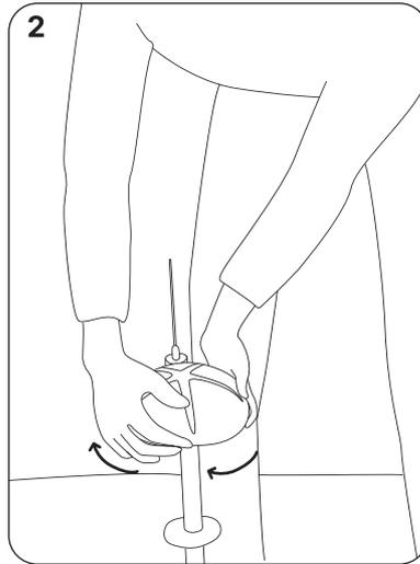
Introduzca el sensor en el orificio y enrósquelo con cuidado, hasta que se mantenga firme en el suelo. No haga fuerza hacia abajo. Asegúrese de que no queden restos (plantas, hojas, etc.) atrapados en el sensor durante la instalación.
