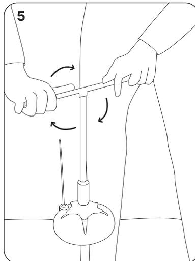
Schrauben Sie den Sensor mithilfe des mitgelieferten Schraubstabs fast komplett ein, bis nur noch ein 1-Finger-Spalt zwischen der Geländeoberkante und der Unterseite des Sensorkopfes bleibt.
