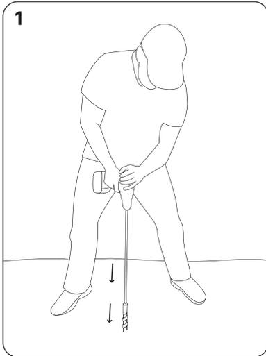
Bohren Sie mit Ihrer Bohrmaschine und dem mitgelieferten Bohrer ein senkrechttes Loch in den Boden. Gegebenenfalls mehrmals bohren und zurückziehen, bis der Bohrer die gewünschte Tiefe erreicht.
