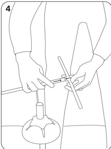
Befestigen Sie den Schraubstab auf dem Sensorkopfadapter.
