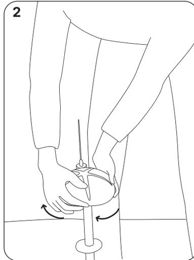
Setzen Sie den Sensor in das Loch ein und schrauben Sie ihn vorsichtig ein, bis er fest im Boden steht. Keinen Druck nach unten ausüben. Vergewissern Sie sich, dass bei der Installation keine Pflanzenreste, Blätter oder Ähnliches auf den Sensor gelangt sind.
