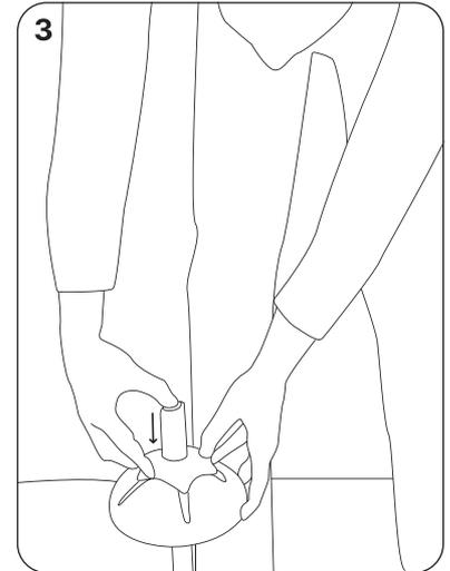
Montieren Sie den Sensorkopfadapter in den Aussparungen oben auf dem Sensorkopf
